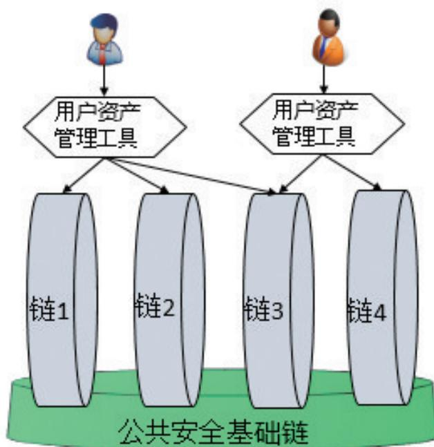
图7 基于分层结构的多链模型
