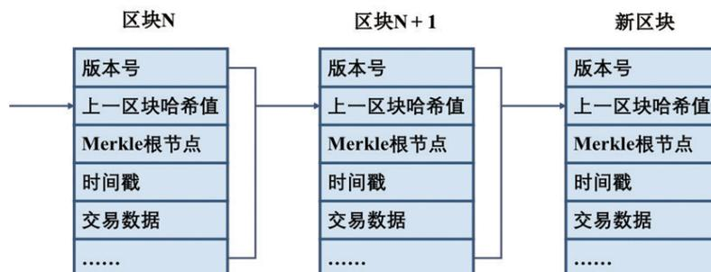
图6 区块链的块链式存储结构
