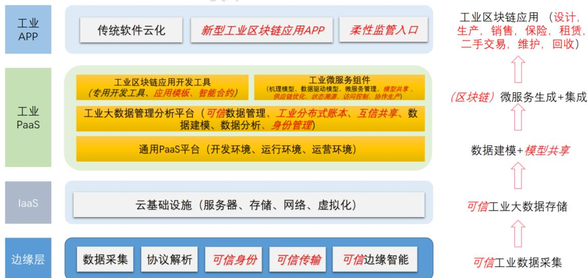
图 4 工业区块链架构图
