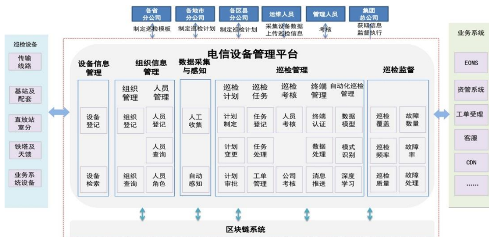
图3 电信设备管理平台的功能架构图
