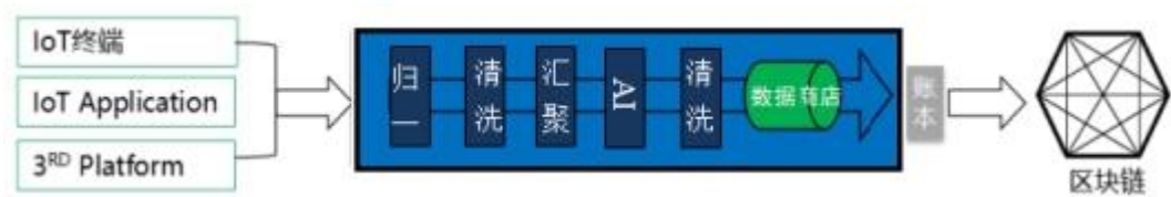
图 21 IoT 平台的区块链数据记账流程图
