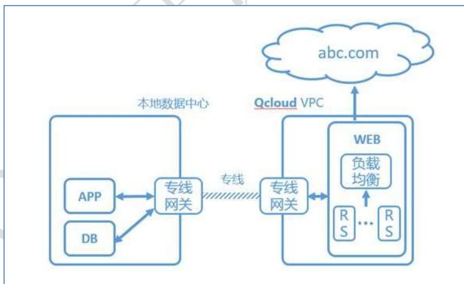
图9 应用部署在公有云的混合云架构
