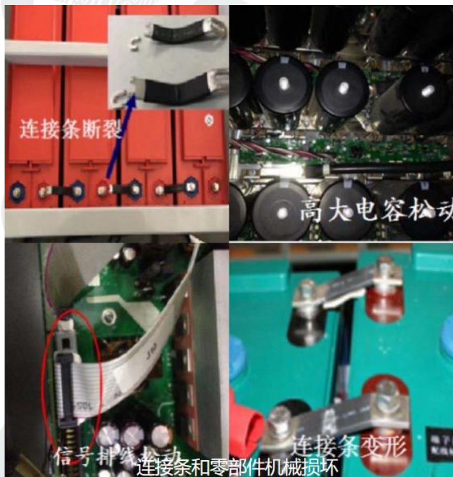
图 29 连接条和零部件机械损坏
